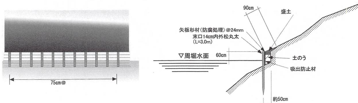
第3図 二子山古墳崩落防止工事設計図
