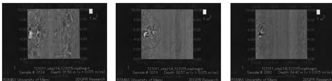
第122図 平成24年度墳頂部探査成果（250MHzアンテナ、左から地表下1.5m、3.57m、4.4m）
