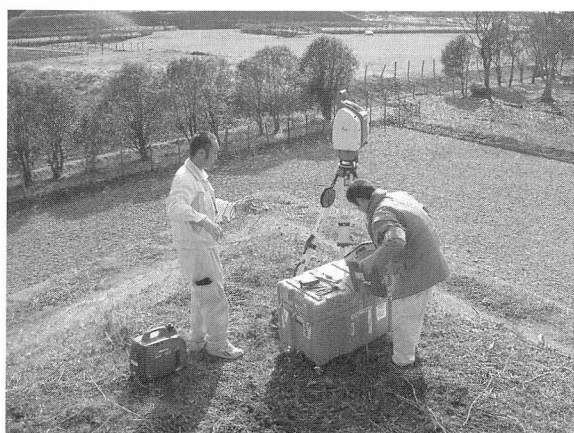
写真8 3Dレーザーシステムの設置
